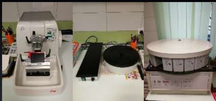
Mikrotóm, vízfürdő és szövetfestő automata
